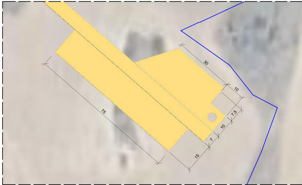
**Detalle 1: Plataforma aerogenerador**
