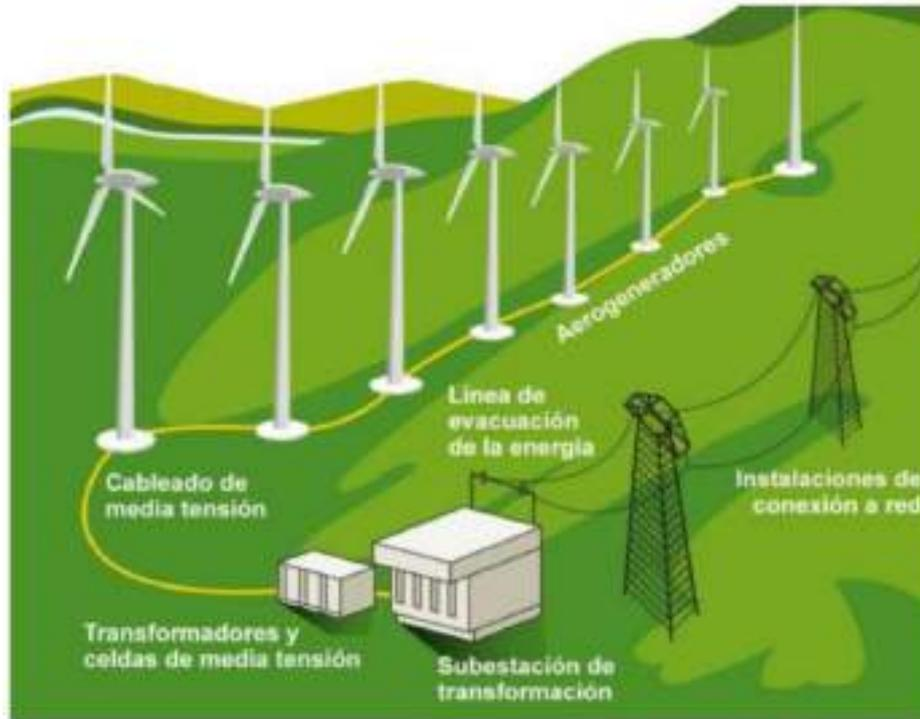
**Figura 3: Esquema de un Parque Eólico (Fuente: Greenpeace)**
