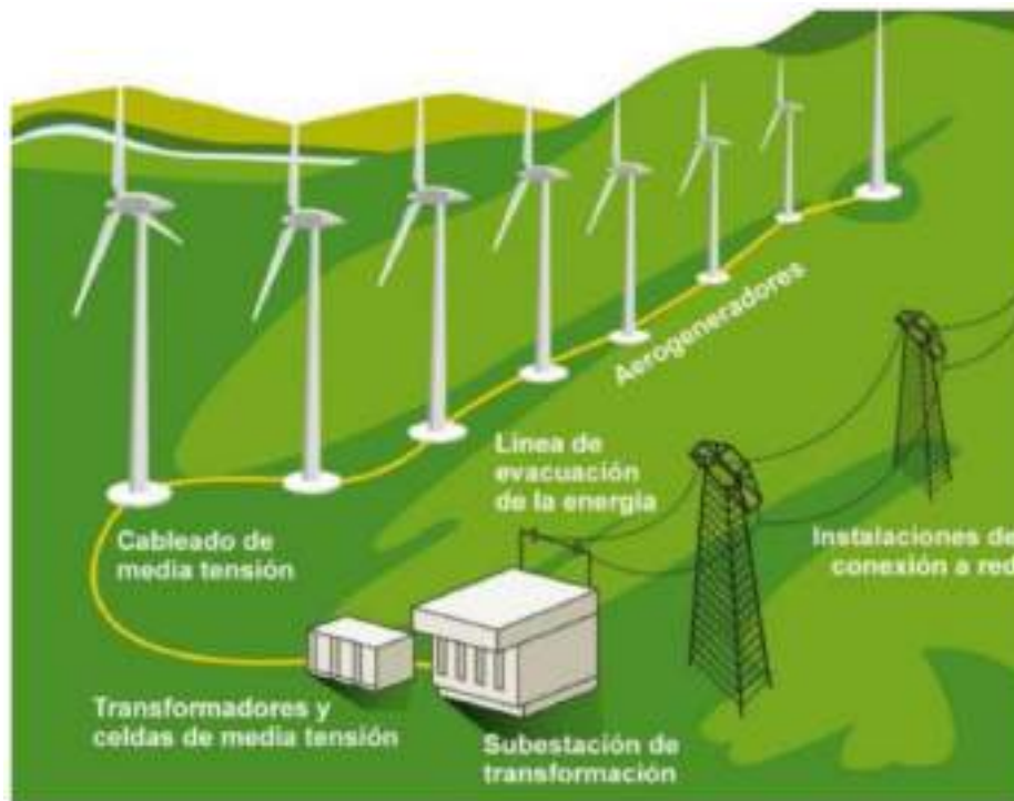
Figura 3: Esquema de una Parque Eólico (Fuente: Greenpeace)
