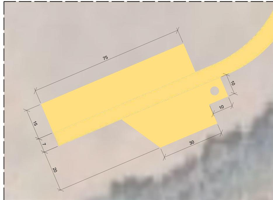
**Detalle 2: Plataforma aerogenerador**
