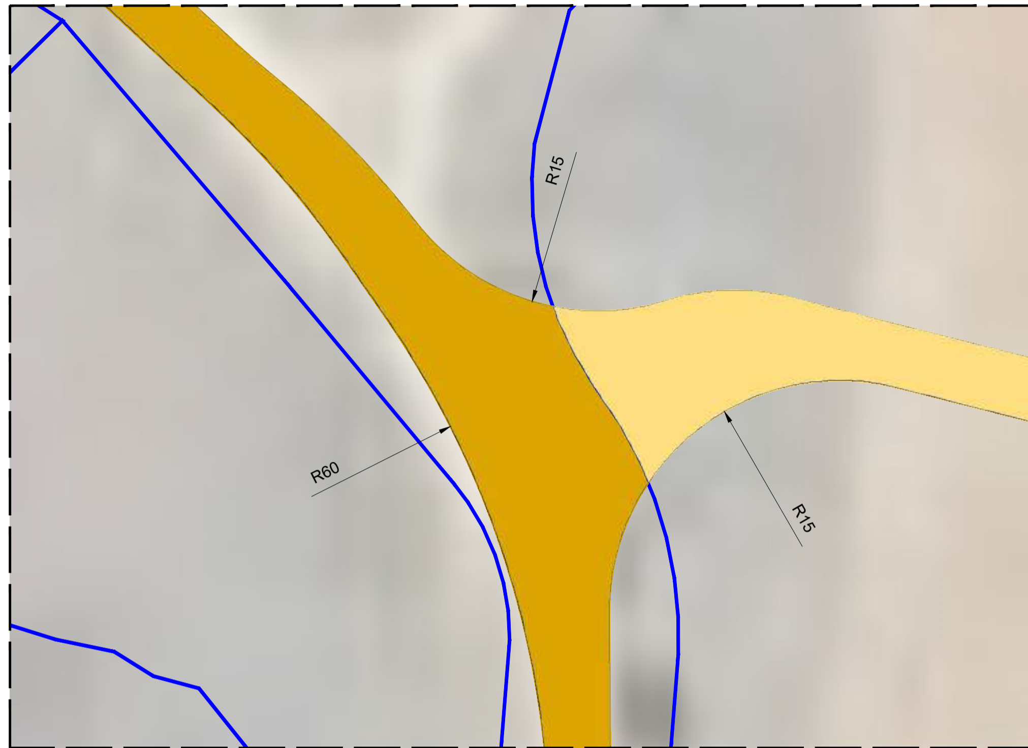
Detalle 1: Acceso SET Escala 1:250
