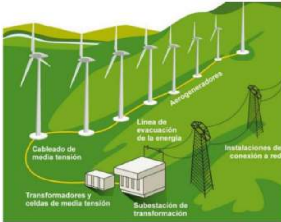
Figura 3: Esquema de una Parque Eólico (Fuente: Greenpeace)
