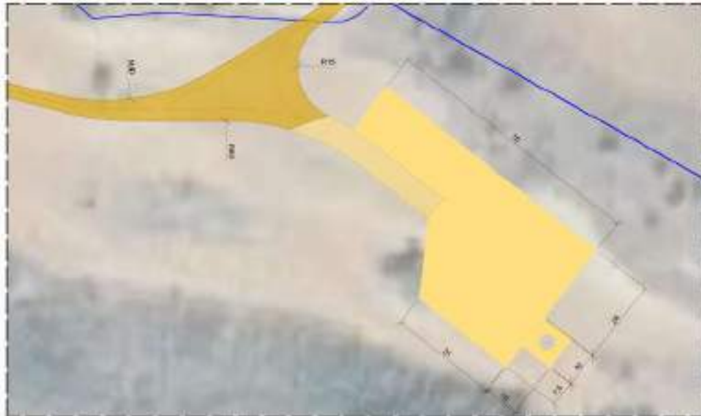
Figura 5: Plataforma de montaje y zonas de acopio aerogenerador
