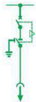
Unidad de protección del transformador
