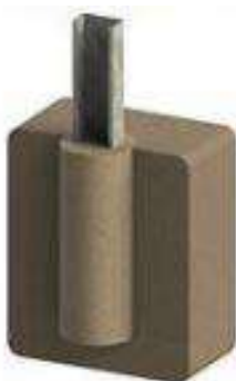
Imagen croquis de cimentación con preperforación
