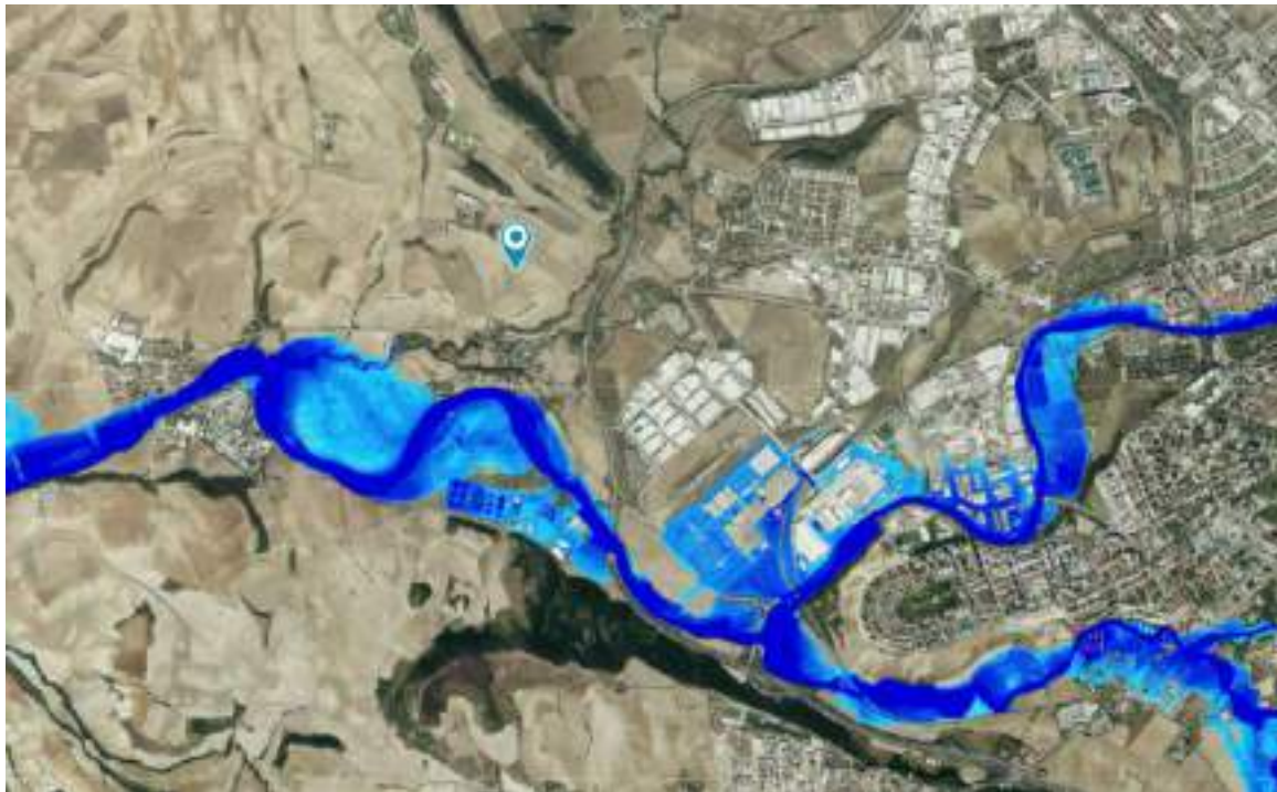
Figura 10. Zona Peligrosidad por inundación fluvial T=500 años. Fuente MITECO
