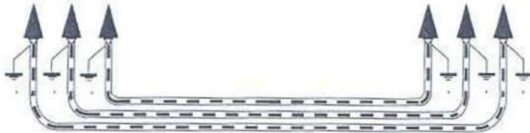
Figura 25: Puesta a tierra de cubiertas metálicas.
