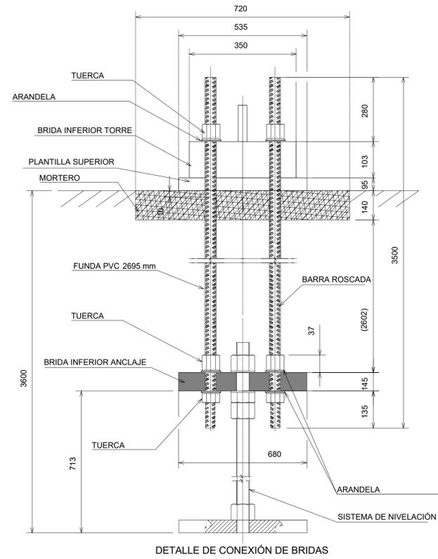
DETALLE DE CONEXIÓN DE BRIDAS
