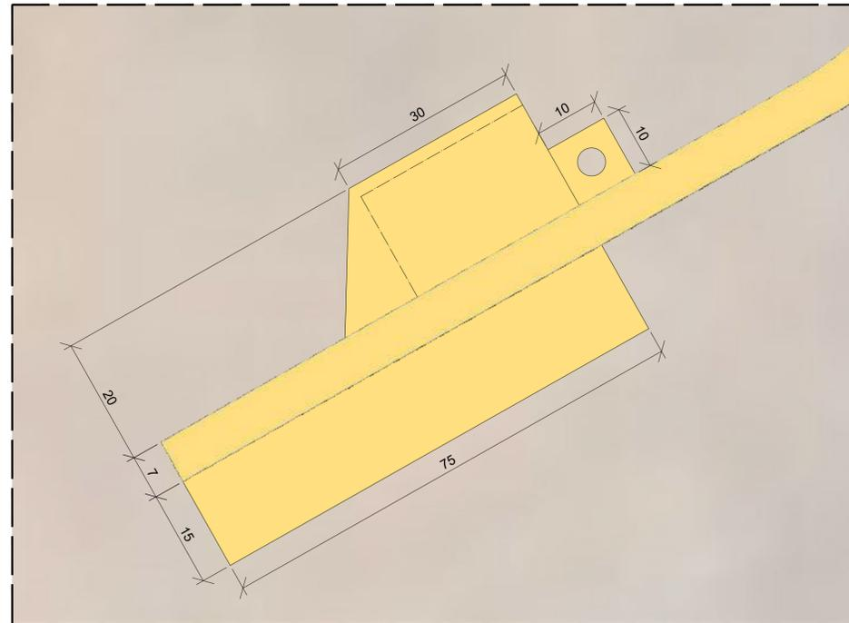
**Detalle 2: Plataforma aerogenerador**
