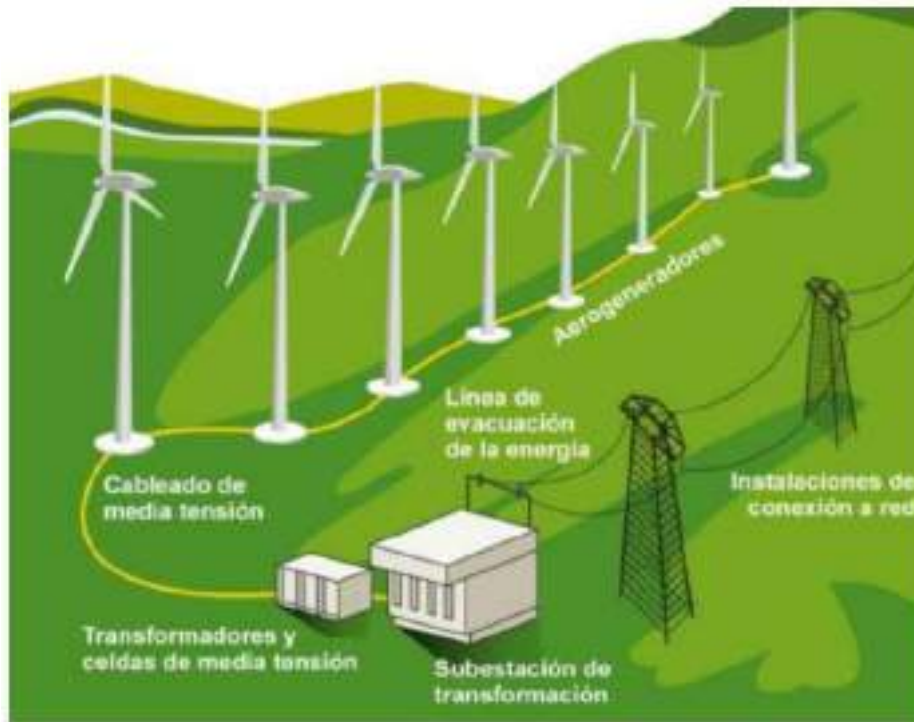
Figura 3: Esquema de un Parque Eólico (Fuente: Greenpeace)
