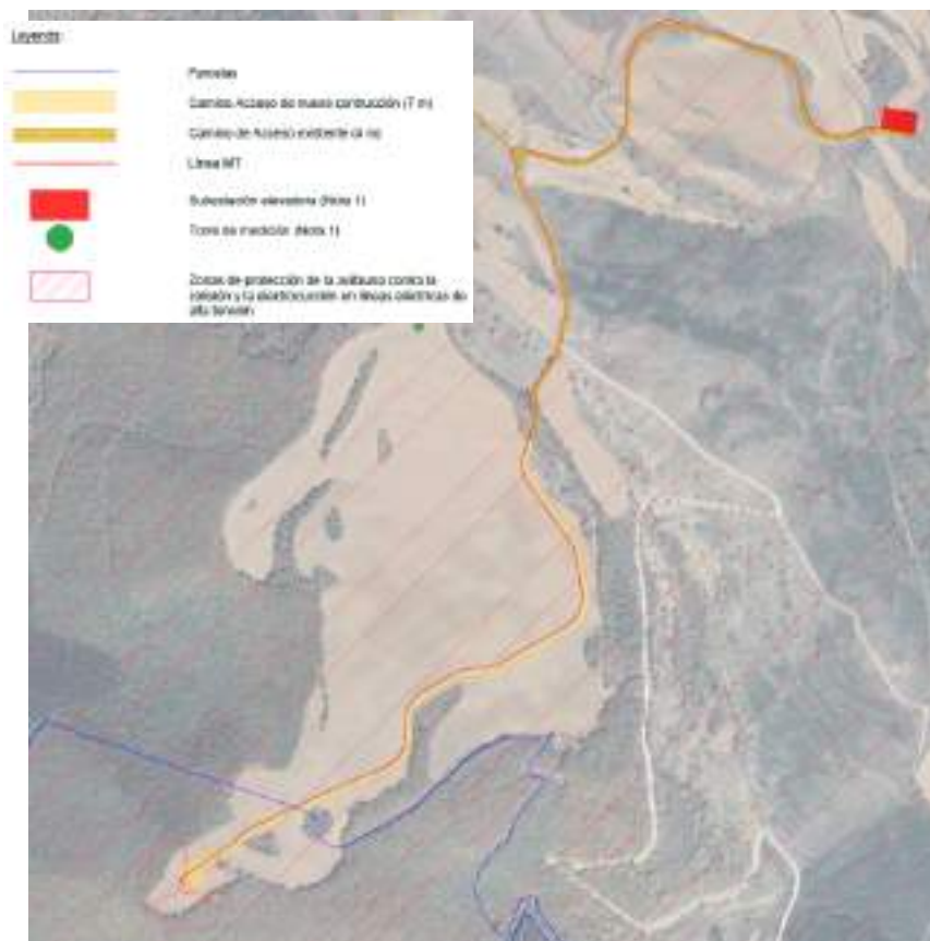
Figura 9. Afecciones del Parque Eólico a Zonas de Protección de la Avifauna
