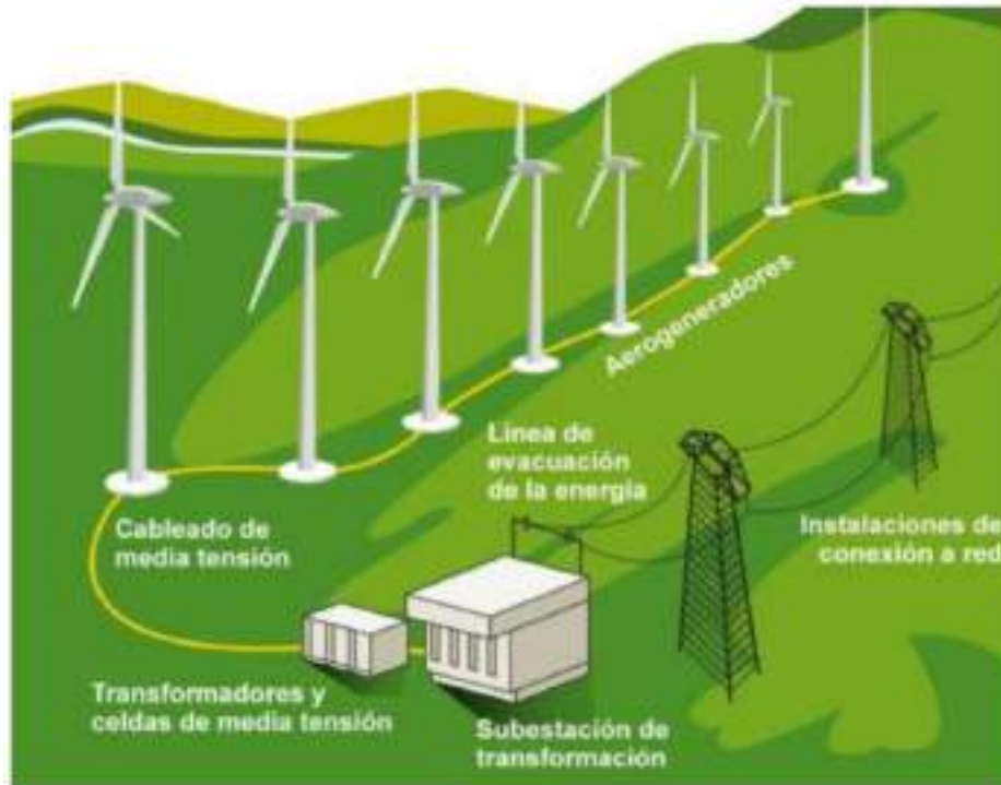
Figura 3: Esquema de una Parque Eólico (Fuente: Greenpeace)
