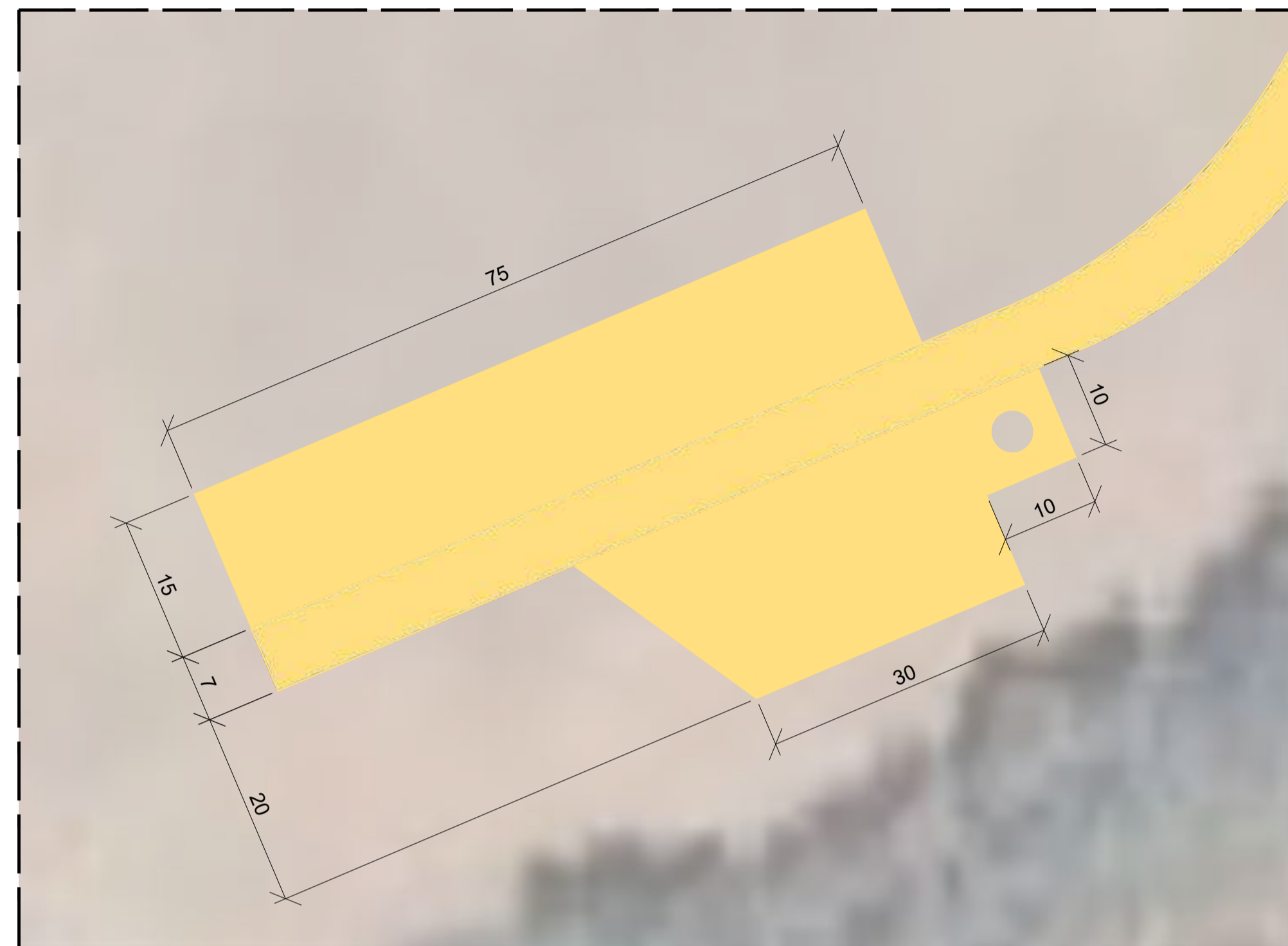
Detalle 2: Plataforma aerogenerador Escala 1:500
