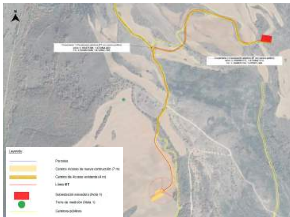
Figura 13. Afecciones del Parque Eólico a caminos públicos
