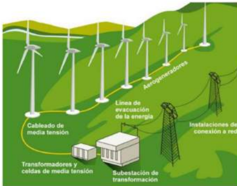
Figura 3: Esquema de una Parque Eólico (Fuente: Greenpeace)
