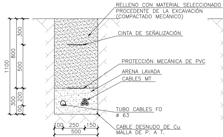
ZANJA TIPO MT 1 CIRCUITO (BAJO TERRENO NORMAL)
