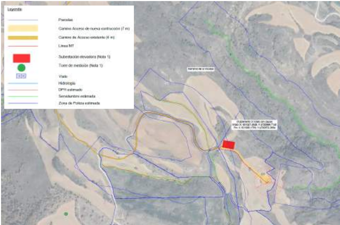
Figura 7. Afecciones del Parque Eólico a la hidrografía
