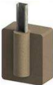
Imagen croquis de cimentación con preperforación
