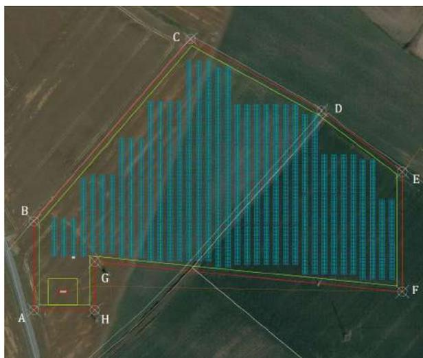
Figura 2. Vallado perimetral - Layout de la Planta Solar Fotovoltaica Orcoyen FF1
