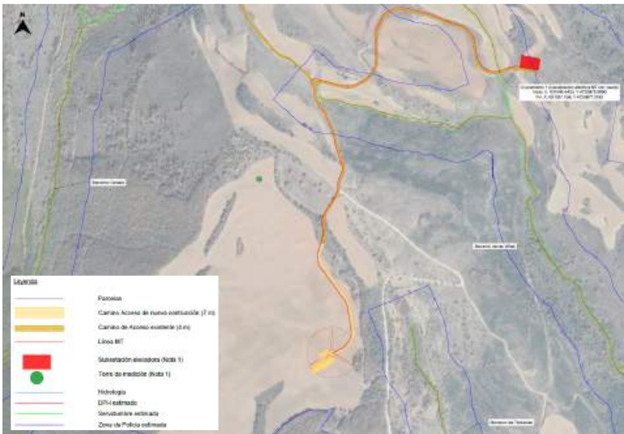
Figura 10. Afecciones del Parque Eólico a la hidrografía
