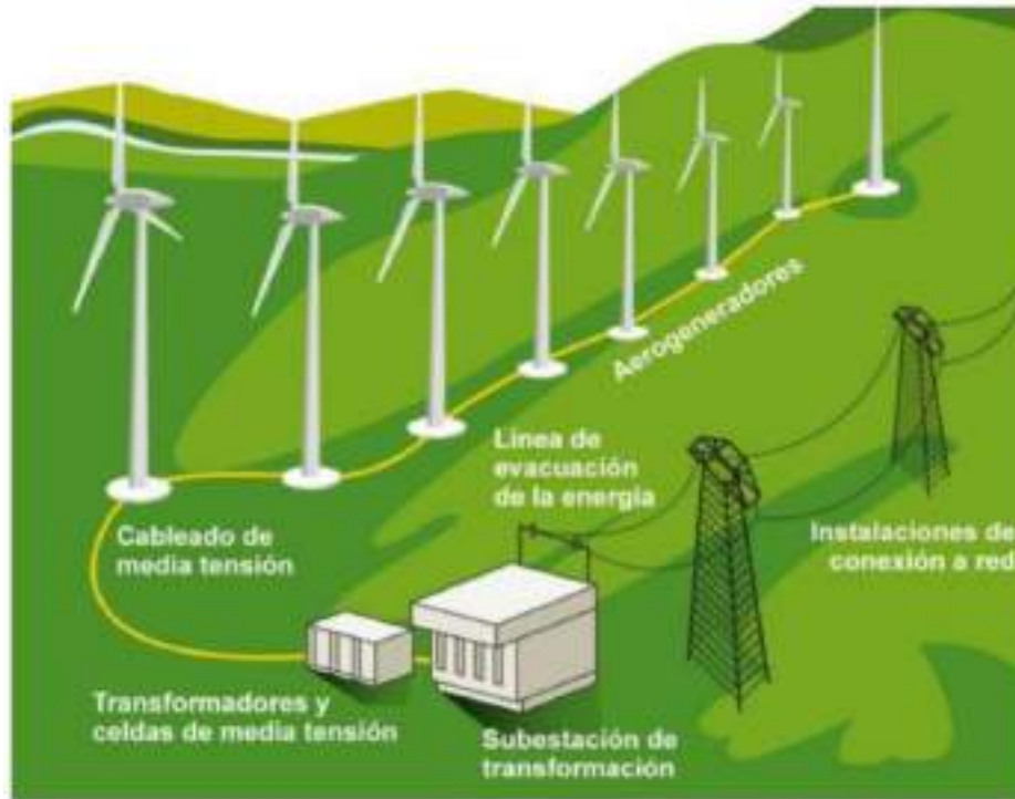
Figura 1: Esquema de una Parque Eólico (Fuente: Greenpeace)
