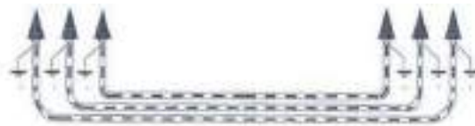
Figura 15. Puesta a tierra de cubiertas metálicas
