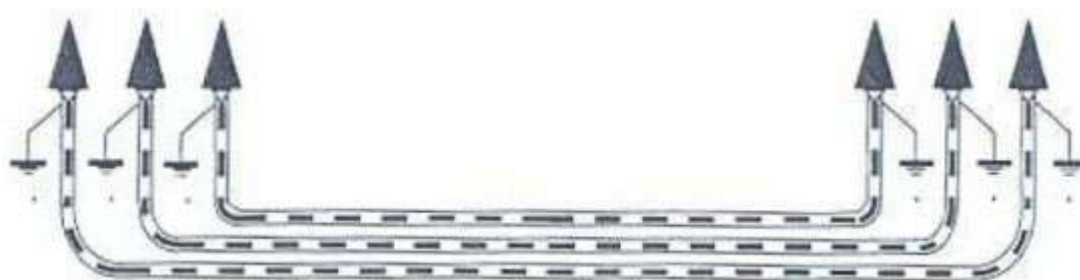
Figura 25: Puesta a tierra de cubiertas metálicas.
