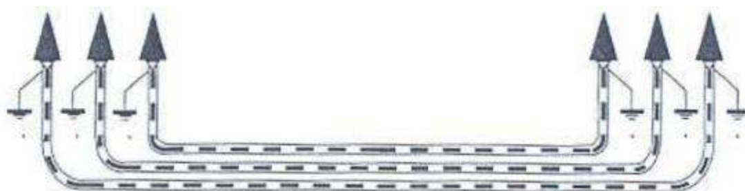
Figura 25: Puesta a tierra de cubiertas metálicas.
