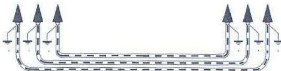
Figura 25: Puesta a tierra de cubiertas metálicas.
