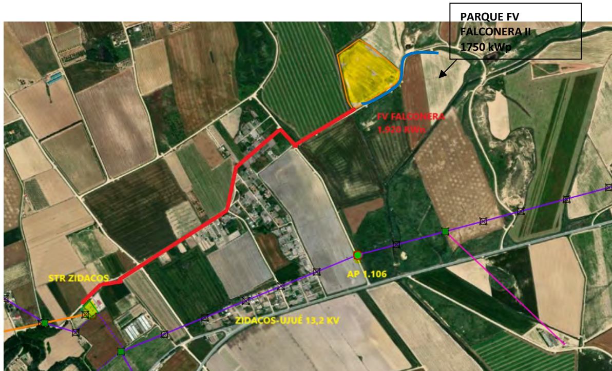
Tendido de la línea de evacuación hasta STR Zidacos
