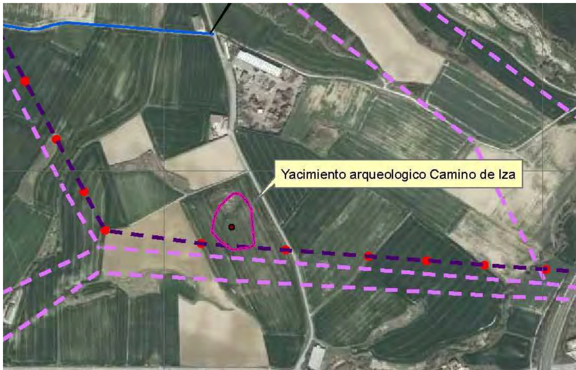
Imagen 6: Perímetro del yacimiento arqueológico Camino de Izas y línea de evacuación en morado, con apoyos como puntos rojos.
