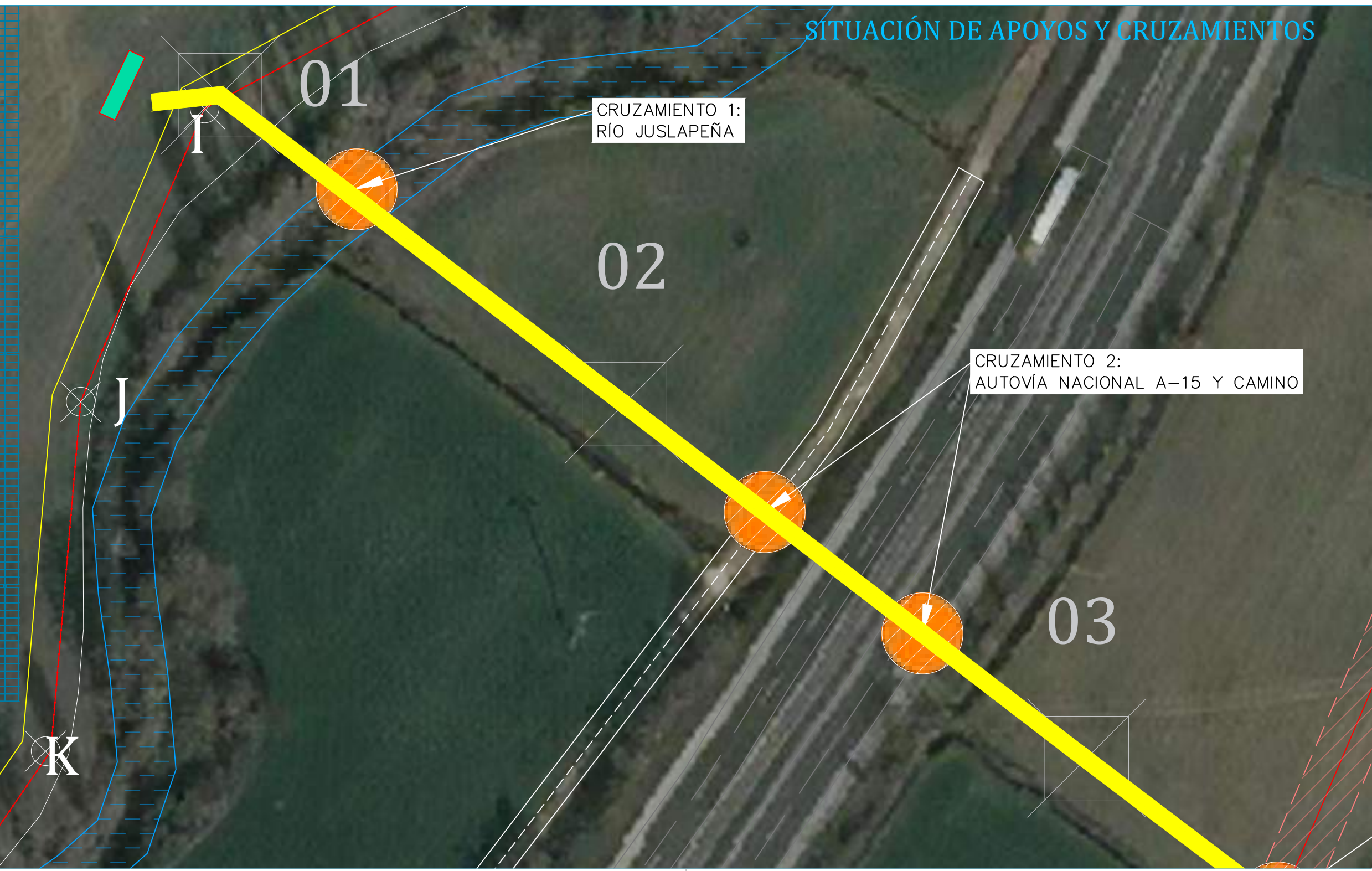
CRUZAMIENTO DE LÍNEA DE EVACUACIÓN ENTRE APOYOS 01 Y 02, CON RÍO JUSLAPEÑA
