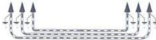
Ilustración 22. Puesta a tierra de cubiertas metálicas
