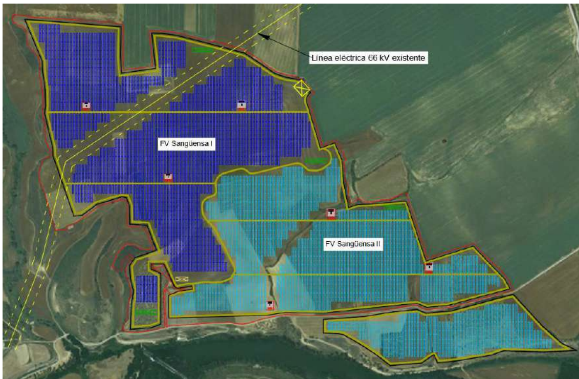
Ilustración 10. Afección línea eléctrica
