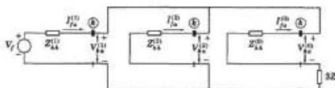
*Figura 4. Circuito Equivalente falta bifásica línea-línea-tierra*
