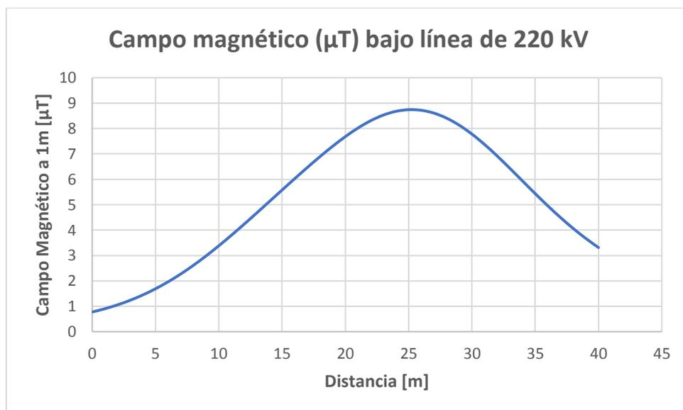
Figura 1. Campo Magnético Línea Tudela (REE) y Línea Colectora 2 220 kV.
