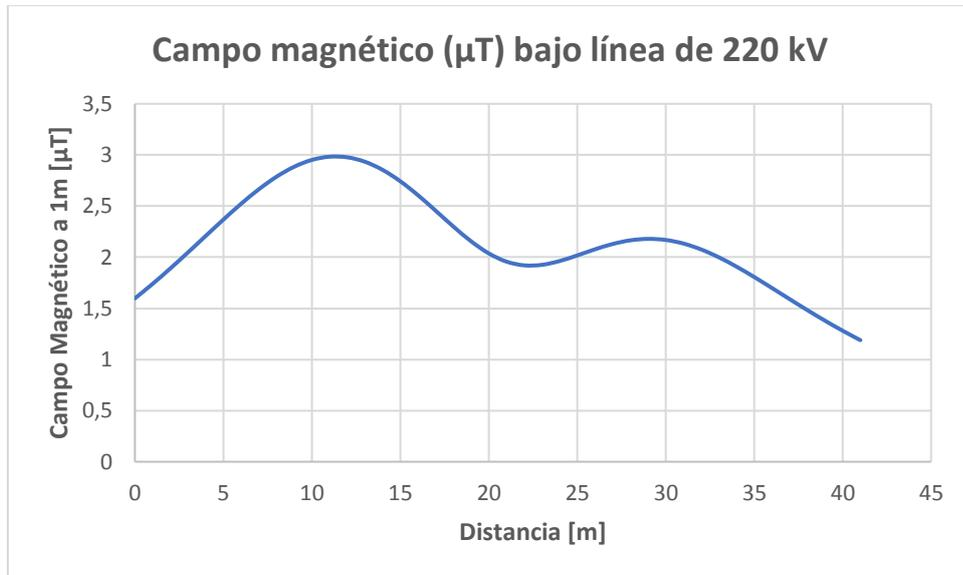
Figura 2. Campo Magnético Línea Tudela y Línea Colectora 2 220 kV.
