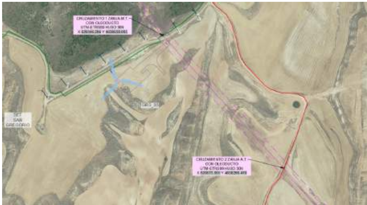
Imagen 1 Afección línea de evacuación con oleoducto.
