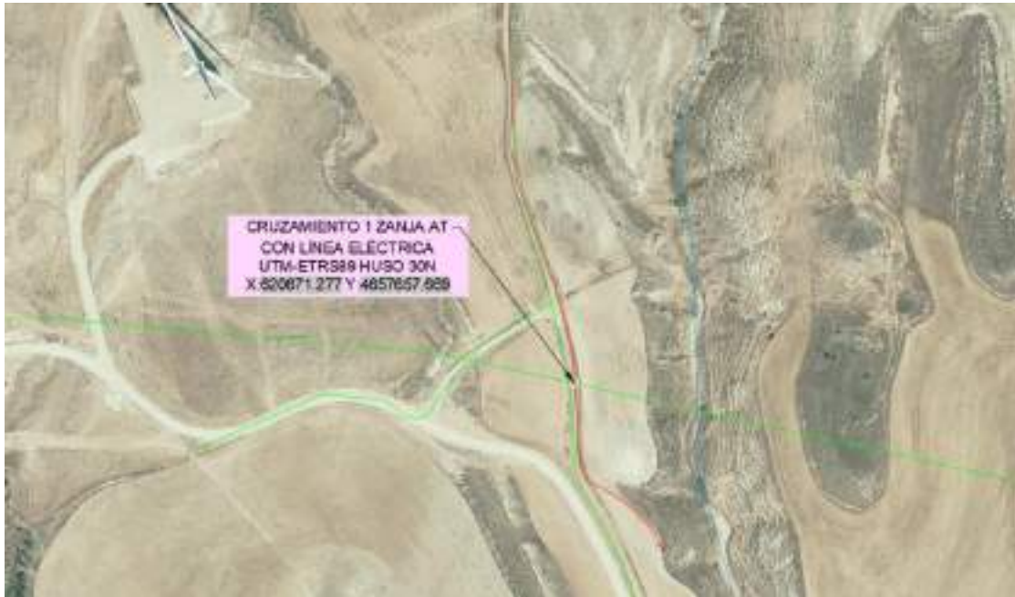
Imagen 1 Afección línea de evacuación con línea eléctrica
