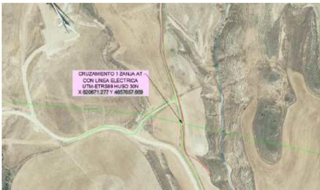
Imagen 1 Afección línea de evacuación con línea eléctrica.
