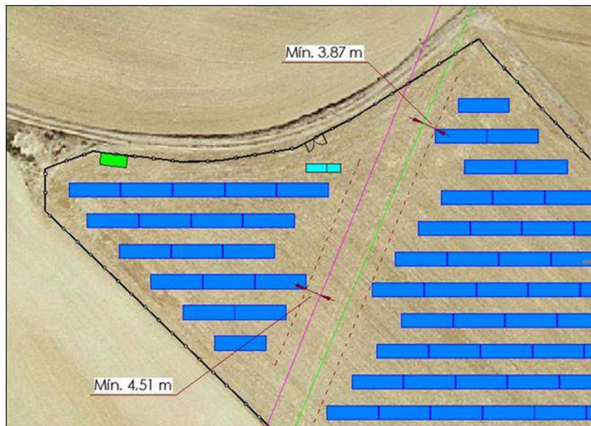
Imagen 6.- Detalle gaseoducto – oleoducto y distancias respetadas. Fuente: Memoria del proyecto
