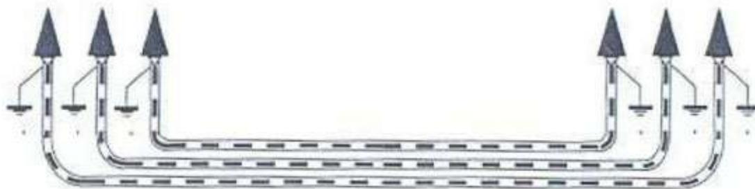
**Figura 10: Puesta a tierra de cubiertas metálicas.**
