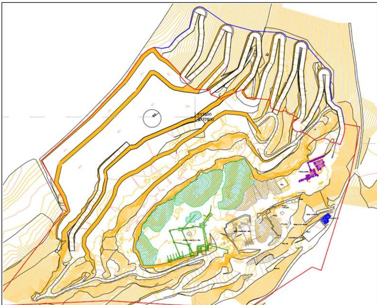
El volumen resultante de esta Fase 2 de acondicionamiento del frente alcanza los 232.370 m<sup>3</sup> según la comparación de modelos digitales de elevación.
