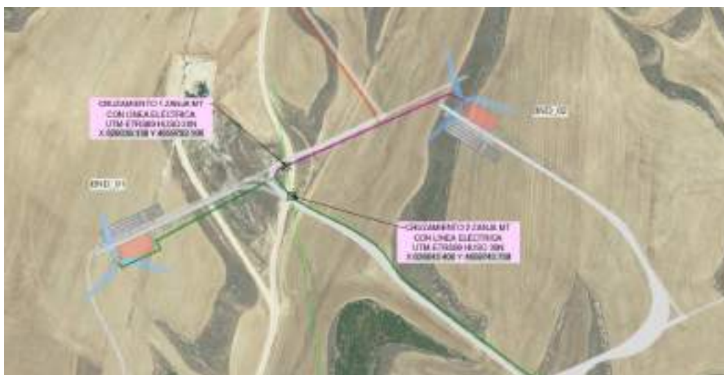
Imagen 15 Afección línea MT con línea eléctrica
