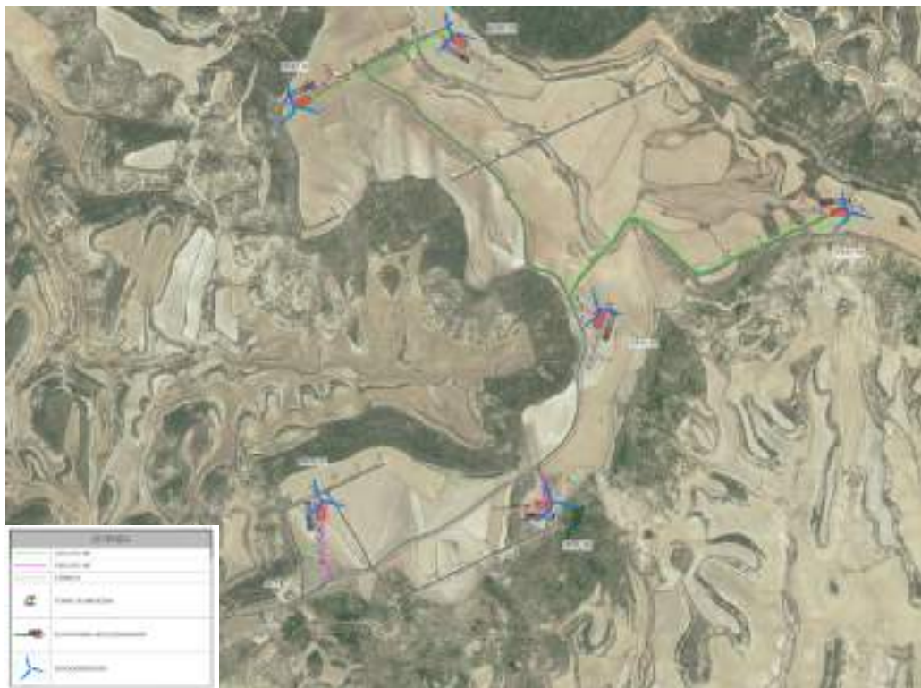
Imagen 11 Distribución eléctrica aerogeneradores
