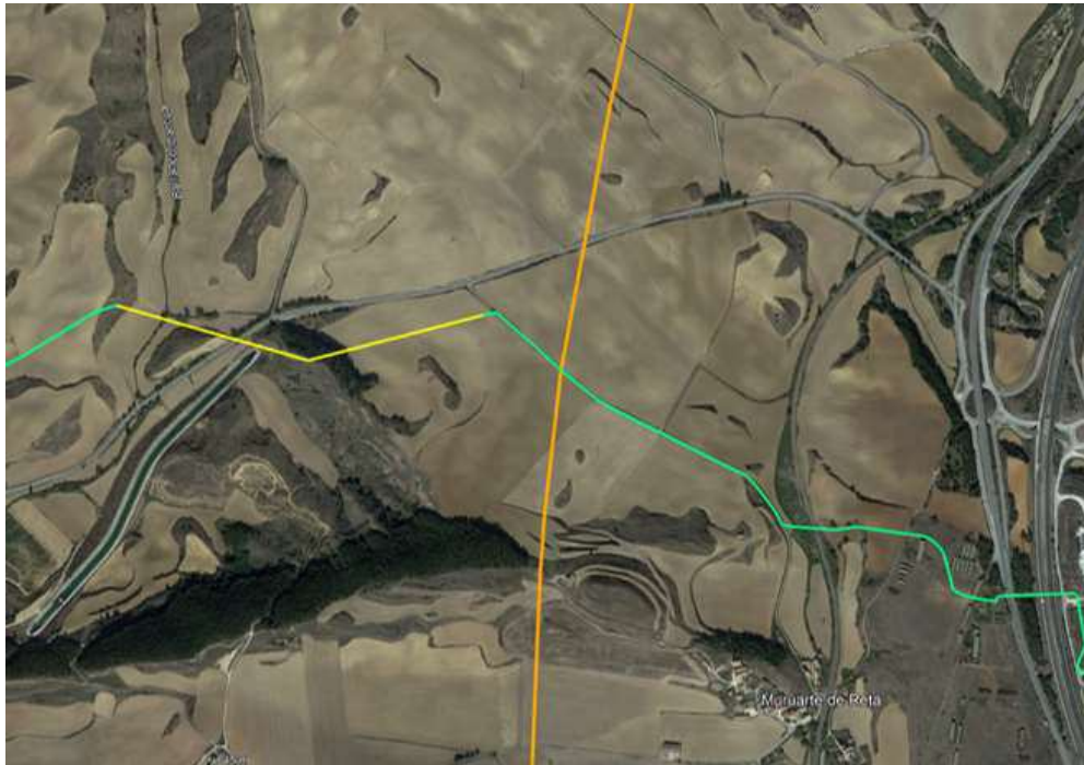
En naranja conducción de Enagás y en verde línea de evacuación subterránea.
