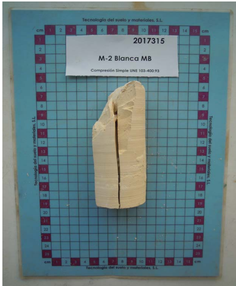
Detalle de la muestra sometida a ensayo
