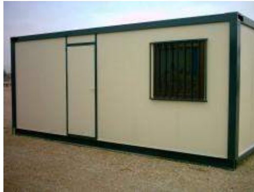
Imagen 7. Contenedor prefabricado para instalaciones provisionales de obra
