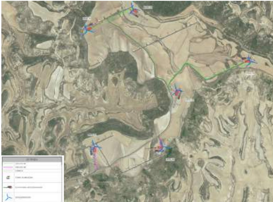
Imagen 11 Distribución eléctrica aerogeneradores
