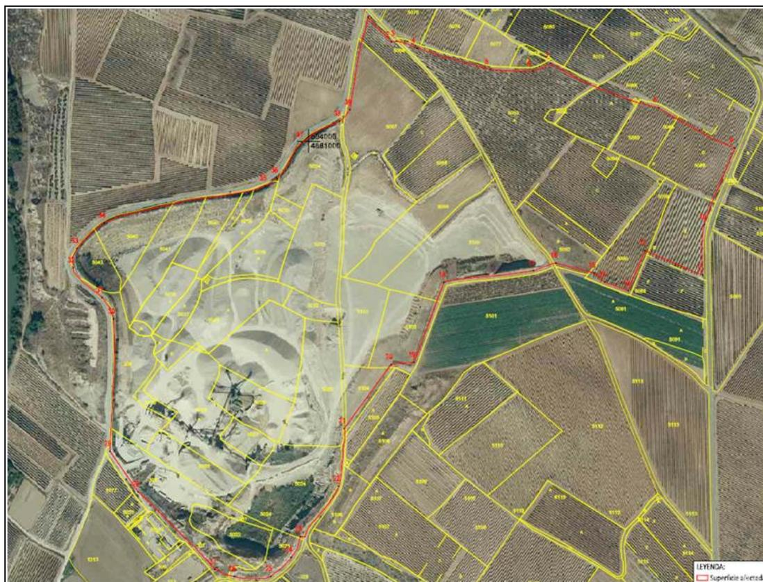
Las labores de restauración avanzan progresivamente conforme lo hace la extracción, por lo que se han ido generando los taludes perimetrales 2H/1V.
