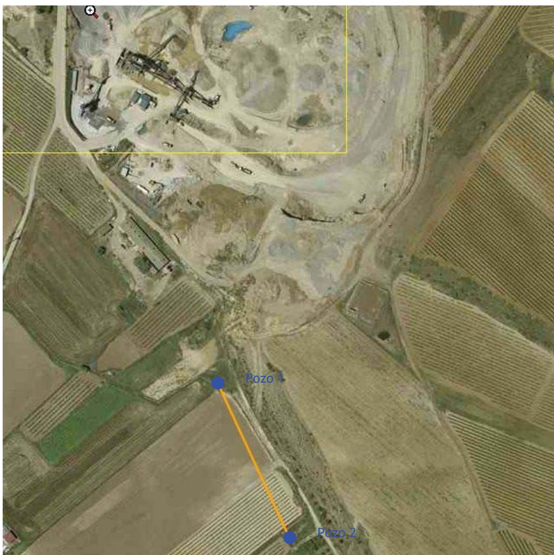
POZO 1: propiedad de la cantera. El 27 de enero de 2010 se mide el nivel freático a -2,45 m, profundidad referida a la rasante topográfica. Se trata de un pozo de anillos de hormigón, en el que se estima que la potencia de gravas se sitúa en torno a los 6,00 m. La distancia desde el pozo a la entrada a la cantera en línea recta es de 247 m. Se extrae un caudal aproximado de 7.000 m<sup>3</sup>/año.
