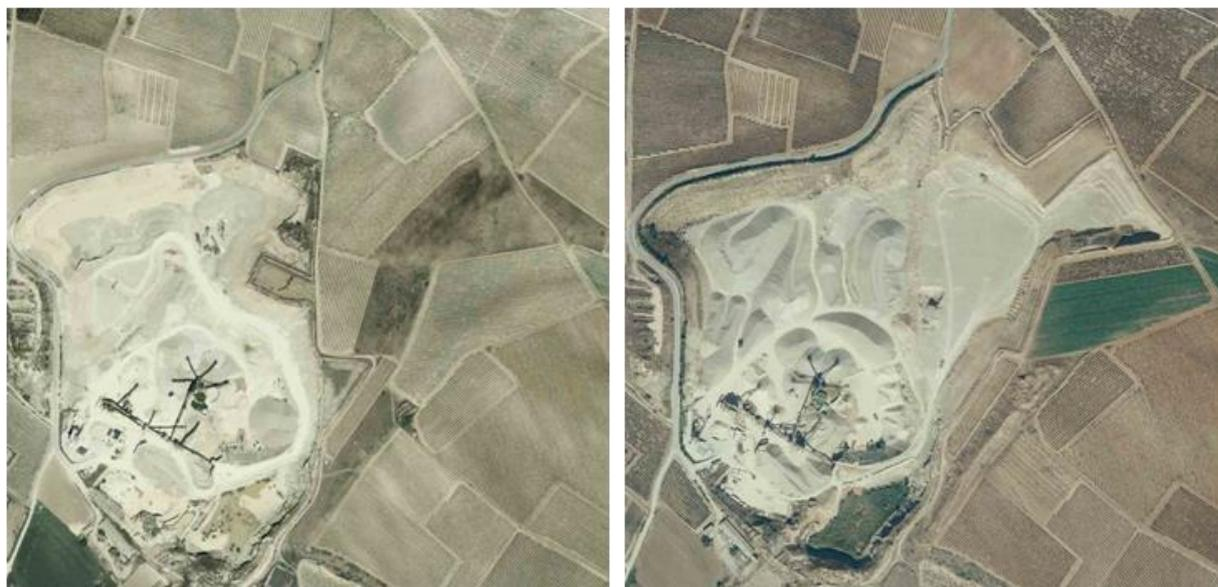
Como se observa, en los taludes al norte de la plaza de acopios se realizaron labores de restauración consistentes en el reperfilado de los taludes, aporte de tierras, etc.
