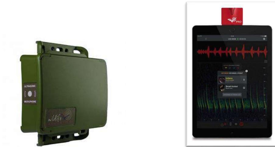
**Figura 2.** Izquierda: grabadora de ultrasonidos Song Meter Mini BAT Full Spectrum (Wildlife Acoustics), utilizada en las estaciones de grabación autónoma. Derecha: micrófono Echo Meter Touch 2 Pro (Wildlife Acoustics) conectado a una Tablet (iPad, Apple) utilizado en los transectos nocturnos.
