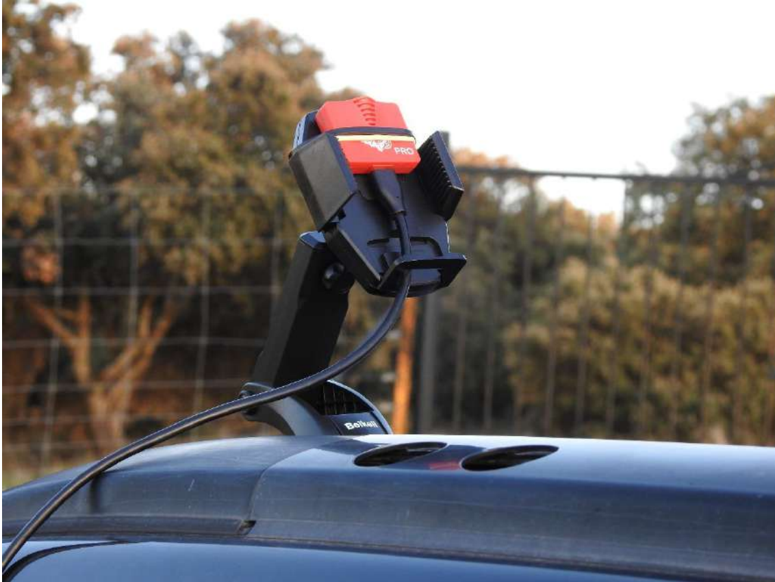
Figura 6. Detalle del sistema de fijación del dispositivo Echometer Touch Pro 2 al vehículo todoterreno para la realización de los transectos específicos.
