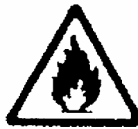
RIESGO DE INCENDIO MATERIAL COMBUSTIBLE
