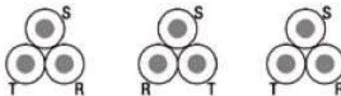
**Figura 16: Colocación de cables en tresbolillo.**
