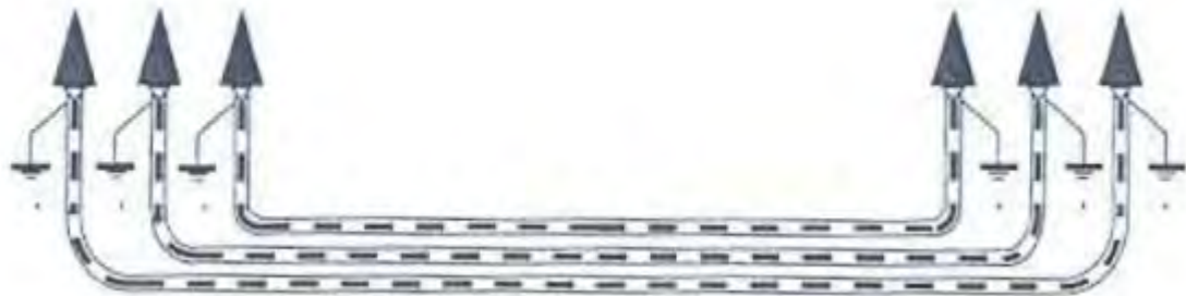
Figura 18: Puesta a tierra de cubiertas metálicas.
