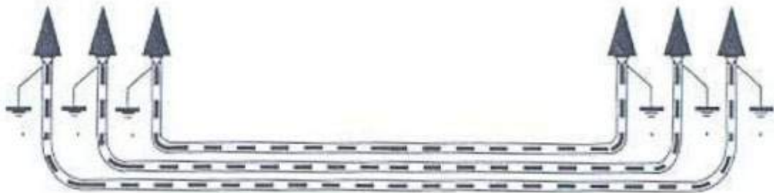
Figura 21: Puesta a tierra de cubiertas metálicas.
