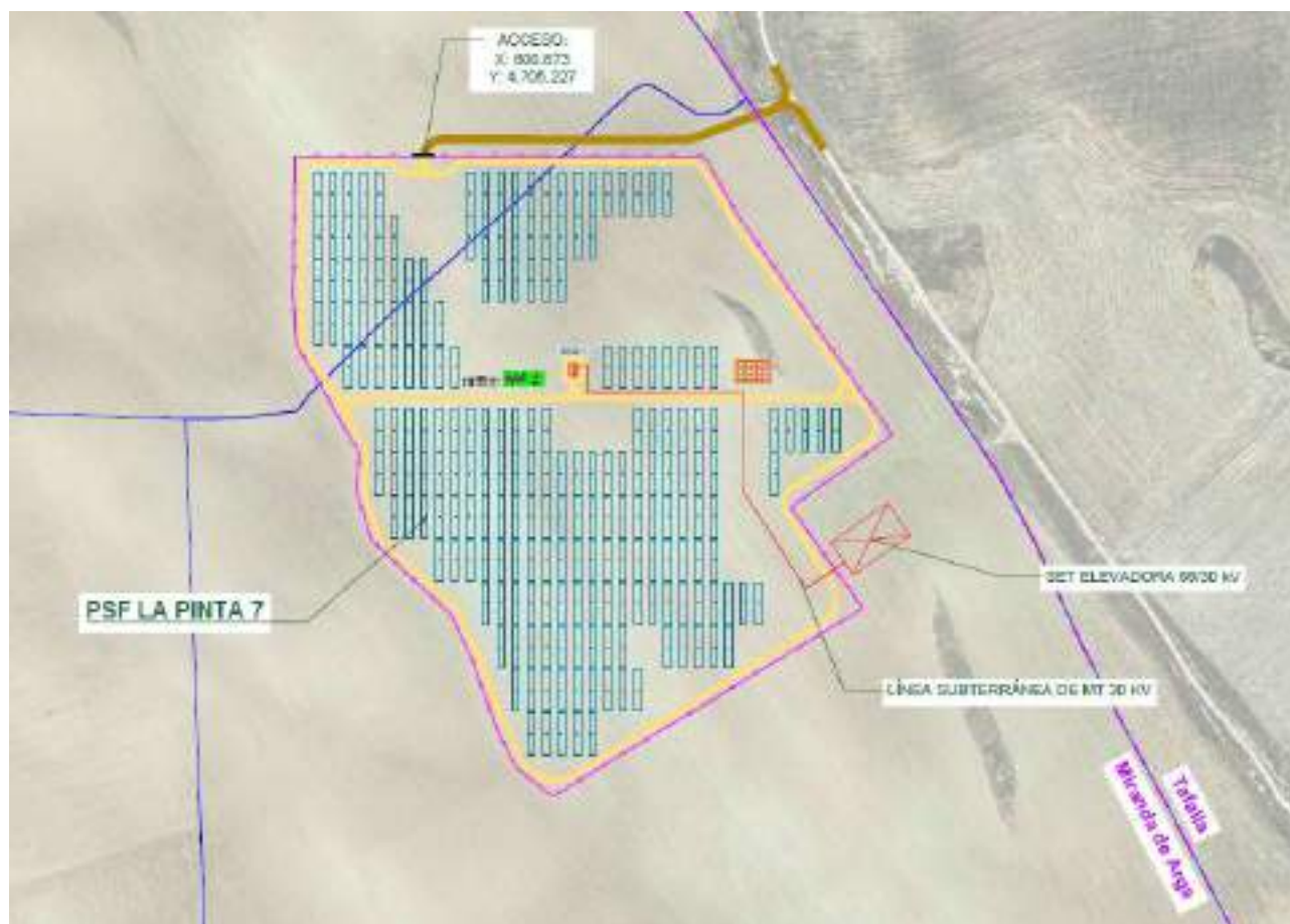
Figura 3: Accesos al Parque Solar FV.
