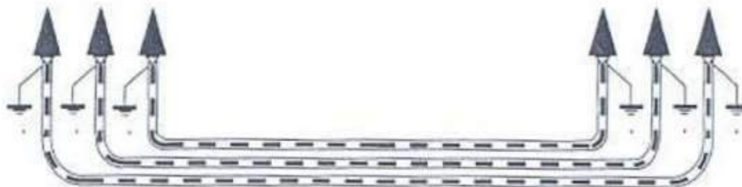
Figura 25: Puesta a tierra de cubiertas metálicas.
